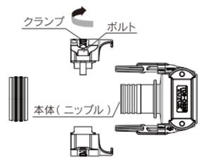
2. ニップルを取り付ける配管に固定してください。次にホース長さの調整を行いながら、ホース端面を垂直に切断してください。ホースの引っぱりの要素が加わらないようご注意ください。
