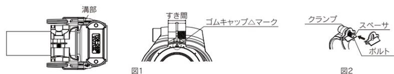
6. ボルト2本を交互に均等に締め込み、すき間がなくなるまで締め上げてください。すき間があり締め切りできない場合は、時間を置いてからクランプのすき間がなくなるまで必ず増し締めしてください。△ 注意 片よりの締め付けでは、締め切りできません。△ 注意 ボルトの締め上げには「六角レンチ」長さ180mm以上( TC6-CS 50は、200mm以上)をご使用ください。△ 注意 締め上げの際に、まれに樹脂や金属の削り粉(又は糸状の物)が発生する場合があります。十分に取除いてからご使用ください。
