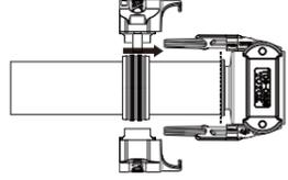
5. クランプをニップルの溝部に合わせて仮り組みします。ゴムキャップ△マークをすき間のセンターに位置するように調整してください。(図1) ※ ボルトからスペーサが脱落した場合は、スペーサをボルトに取り付けてからクランプを仮り組みしてください。(図2)
