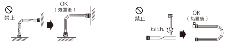
例1) 配管時のホースのねじれ 例2) 曲げたときのねじれ
